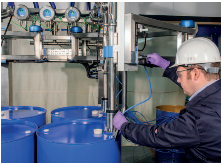
Afb. 1 Het Newson Gale aardingssysteem aardt en controleert metalen onderdelen naar 10 Ohm
