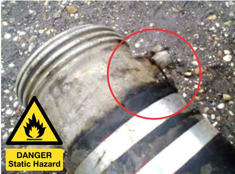
Les fils hélicoïdaux métalliques qui renforcent les tuyaux contre les pressions d'évacuation et d'aspiration sont couramment utilisés pour assurer la continuité électrique entre les raccords d'extrémité ou les raccords de tuyaux. Il est important de vérifier que les fils conducteurs du tuyau (voir illustration) ne sont pas rompus car cela entraînerait la présence de conducteurs isolés susceptibles de produire des étincelles électrostatiques pendant le transfert du matériau.
