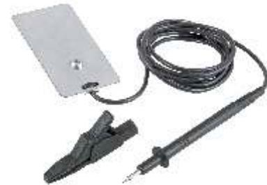
Le kit d'extension (OGC/EXT) est composé d'une pince crocodile, d'une sonde de test et d'une plaque en inox. Il est idéal pour tester les équipements qui n'ont pas une surface suffisamment grande pour permettre de connecter la pince du OhmGuard. L'opérateur en charge du test connecte simplement la pince du OhmGuard à la plaque puis connecte la sonde ou la pince crocodile sur l'équipement à tester.
