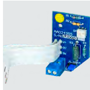
Circuit imprimé de commutation à sécurité intrinsèque
